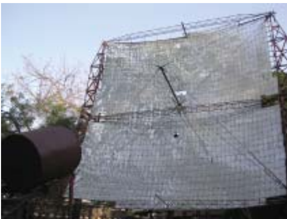
Reflector parabólico desarrollado per Wolfgang Scheffler de 50 m 2 instalado en la India donde se estudia la incineración de cadáveres con energía solar concentrada.
